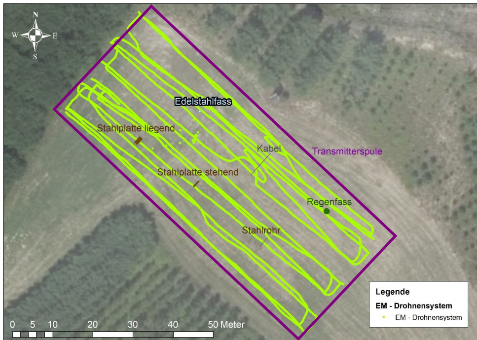
Abbildung 14: Lageplan der EM-Drohnenmessung an der Testsite in Pöverding (Messlinien Receivereinheit in grün, ausgelegte Transmitterspule in violett)
